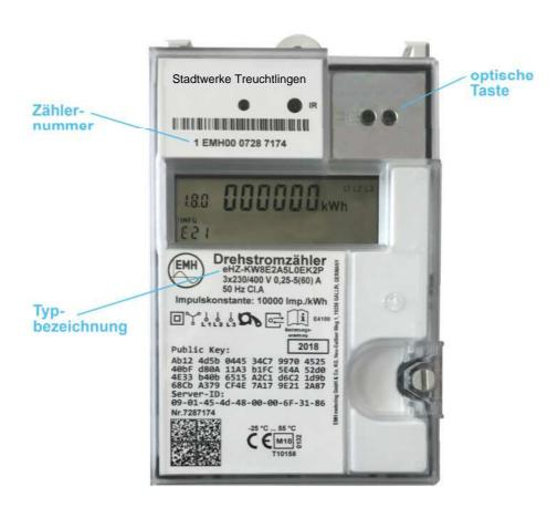
Die optische Taste ist ein lichtempfindlicher Sensor, der nicht auf Berührung, sondern auf den fokussierten Lichtstrahl einer handelsüblichen Taschenlampe reagiert. Damit wird die untere Zeile des Displays bedient.
